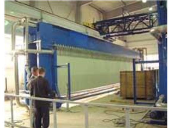
В настоящий момент, большинство коммунальных и промышленных предприятий России для уменьшения объемов образующихся осадков используют технологический процесс их обезвоживания с помощью специальной техники (камерные и ленточные пресс-фильтры, центрифуги).
